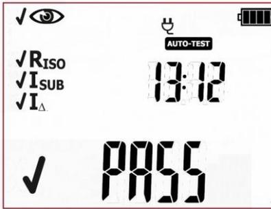
Positives Gesamprüfergebnis des Prüflings. Das Ergebnis jeder Einzelmessung des Prüfablaufes war positiv. Die grünen LEDs der PASS Anzeige leuchten. Rechts daneben wird die aktuelle Uhrzeit angezeigt.
