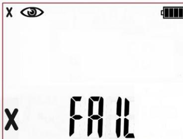
Negative Sichtprüfung. Rote LEDs der FAIL Anzeige leuchtet.
