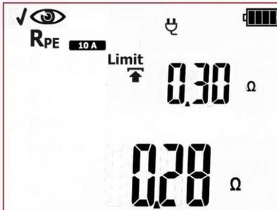
Positives Ergebnis der Sichtprüfung. **Der PAT startet automatisch die nächste Messung: RPE.**
