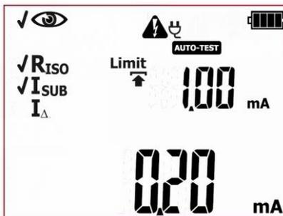
Ersatzableitstrommessung ist beendet. Liegt ein negatives Messergebnis vor, wird keine weitere Messung durchgeführt. Liegt ein positives Testergebnis vor:
